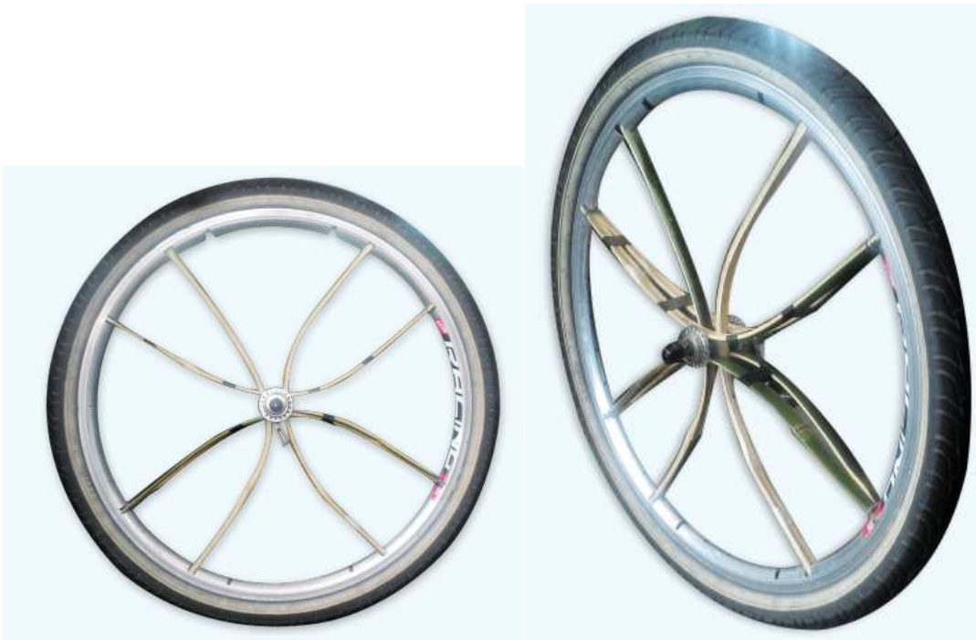
Figuras 8 e 9: protótipo desenvolvido pelos alunos no qual os aros tradicionais de uma roda de bicicleta são substituídos pelos aros em bambu.
