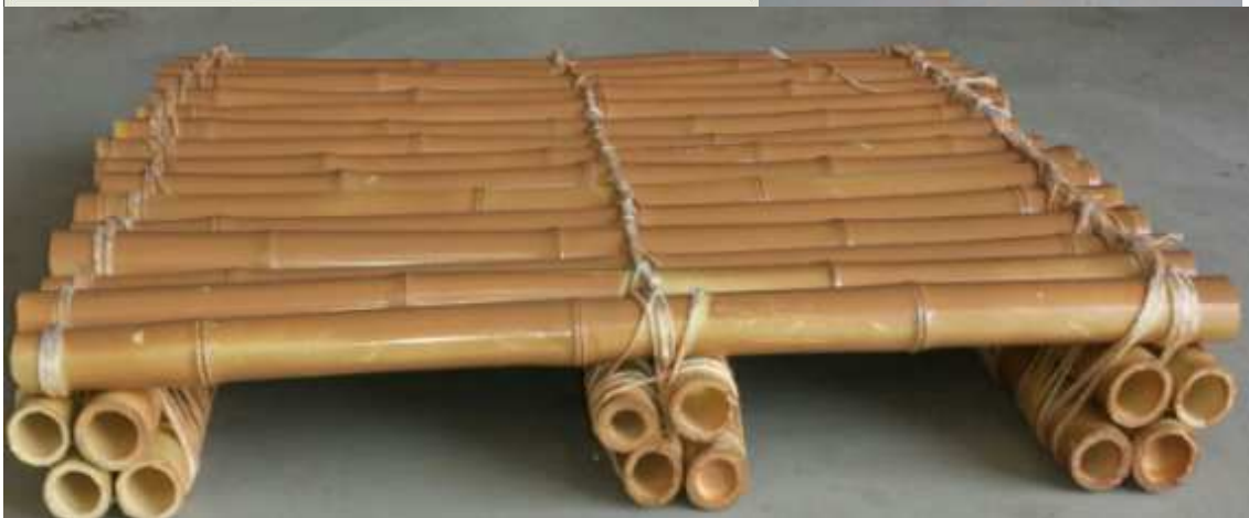
Figuras 14, 15 e 16: desenho técnico do palete de bambu, teste de carregamento no qual o palete suportou 540 Kg e detalhe do palete de bambu.
