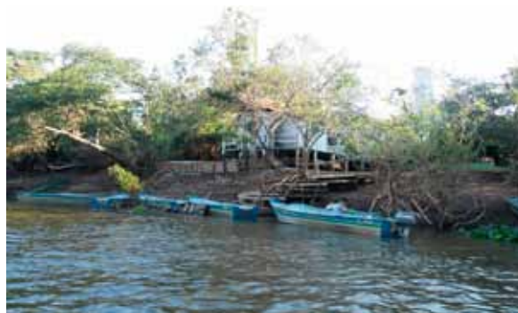
Figura 09 e 10. Vista de um conjunto de casas sobre palafitas, típica de ribeirinhos, percebe-se a estrutura que eleva o imóvel com o intuito de buscar refúgio em períodos de cheia, o emprego da madeira e a tipologia que preza a funcionalidade, a quantidade de barcos encostados sugere que ali se encontra um grupo grande de pescadores. Edificações ribeirinhas convertidas em pousadas, relatadas pelos moradores como grande atrativo para os turistas que vem passar temporadas na região enquanto pescam. Foto: Vinicius Martins de Oliveira (2016).
